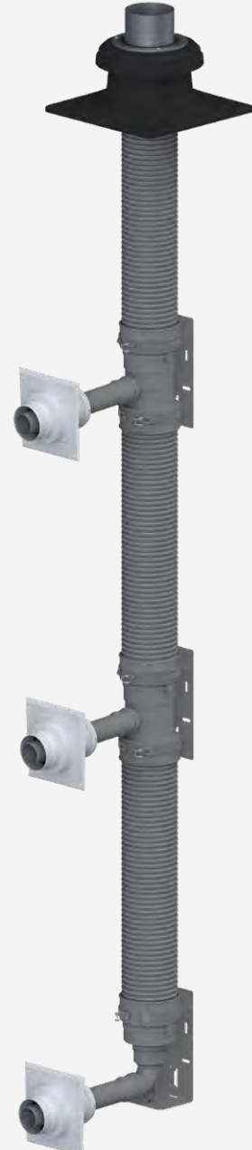
MultiFlex Gemeenschappelijke rookgasafvoer (aftakkingen 60 mm) • 100 mm MultiFlex-systeem: drie tot vier verdiepingen mogelijk • 130 mm MultiFlex-systeem: vijf tot zes verdiepingen mogelijk
